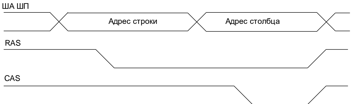
Рисунок 3.4.2 – Временные диаграммы сигналов ввода адреса в микросхему DRAM
